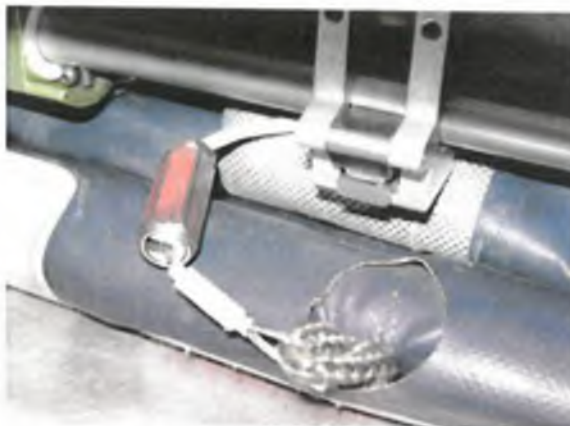
Рисунок 3 – Правильное положение разъема
